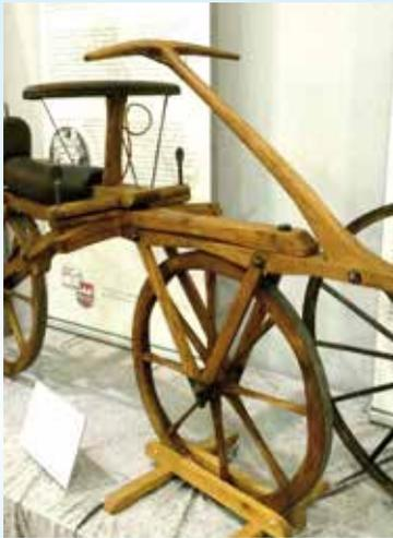
Um eine von Pferden unabhängige Fortbewegung zu ermöglichen, experimentiert Freiherr von Drais und erfindet 1817 die "Draisine". Immerhin sind 14 km pro Stunde mit dem Laufrad zu schaffen, viel mehr als zu Fuß. Aber das Gerät kann sich nicht durchsetzen und verschwindet wieder für viele Jahre in der technischen Versenkung.
