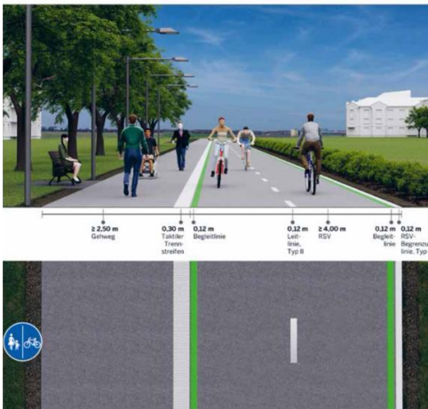
Abbildung 1: Eigenständig geführte RSV im Zweirichtungsverkehr (Skizze)
